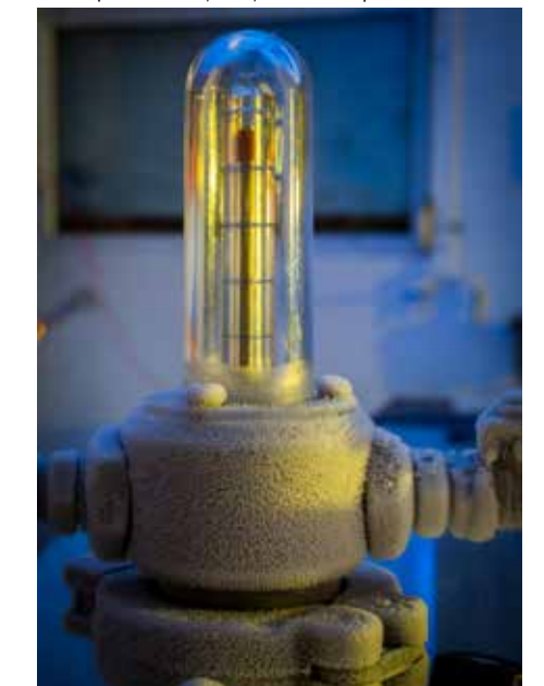
Tête de soutirage du bidon du spectromètre de masse hybride Solarix XR FT-ICR
