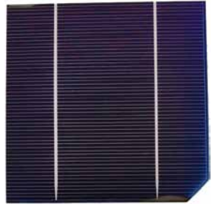
Cellule solaire de type PERC silicium avec couche antireflet remplacée par une couche à conversion de fréquence
