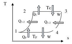
Le cycle doit être parcouru en sens inverse du cycle moteur
