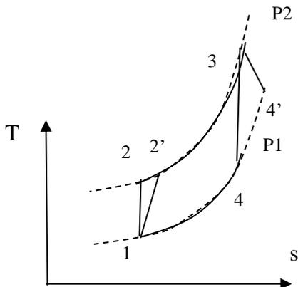
2°-b) Avec les hypothèses de l'énoncé :  $\eta_c = (T_2 - T_1)/(T_2' - T_1)$  et  $\eta_T = (T_4' - T_3)/(T_4 - T_3)$
