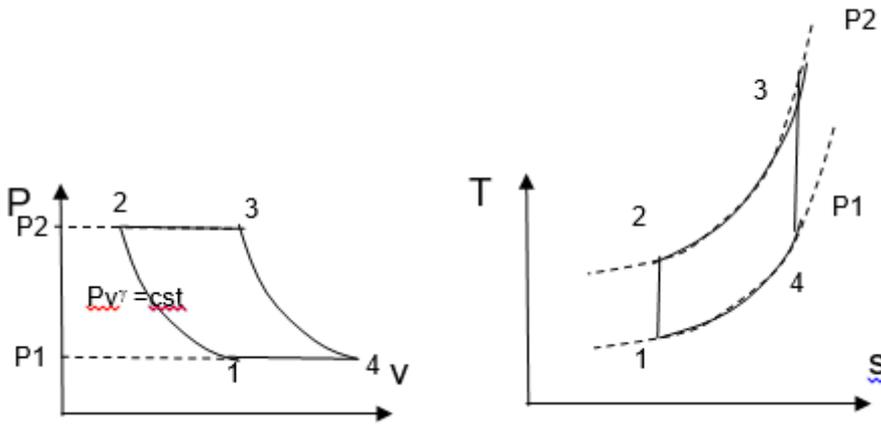
1°-b)  $W_{net} = -[(h_3 - h_4) - (h_2 - h_1)]$ ,  $Q_1 = h_3 - h_2$
