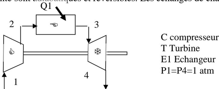
1°-a) donner, pour l'unité de masse, l'allure d'un cycle sur le diagramme (P,v) et (T,s).
